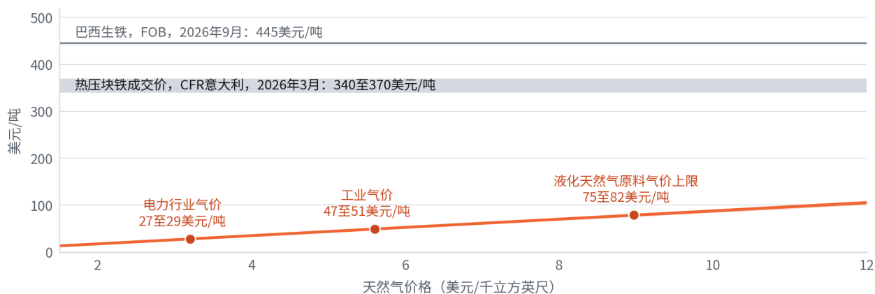
推算 图7.2 按喀麦隆气价，每吨直接还原铁的燃料成本为27至51美元。橙色区间对应每吨9.2至10吉焦；圆点为SNH 2025年对电厂和工业的售价及液化原料气价上限；灰色区间为热压块铁和生铁的市场价格。 资料来源：SNH 2025年气价[S05]；直接还原用气[S39][S41]；SteelOrbis, 2026年3月16日，热压块铁CFR意大利[S18]；GMK Center, 2026年10月4日，巴西生铁FOB[S99]。
