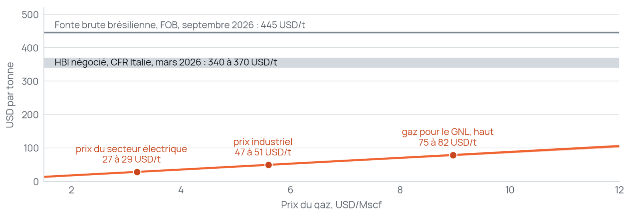
DÉRIVÉ Figure 7.2. Aux prix camerounais du gaz, le combustible coûte 27 à 51 USD par tonne de DRI. La bande orange couvre 9,2 à 10 GJ par tonne ; les points indiquent les prix 2025 de la SNH pour la centrale électrique et pour l'industrie, ainsi que le haut de la fourchette du prix du gaz destiné au GNL. Les bandes grises représentent les prix de marché du HBI et de la fonte brute.
